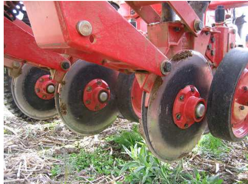
Semeato Doppelscheibenschar- Direktsaatsämaschine
